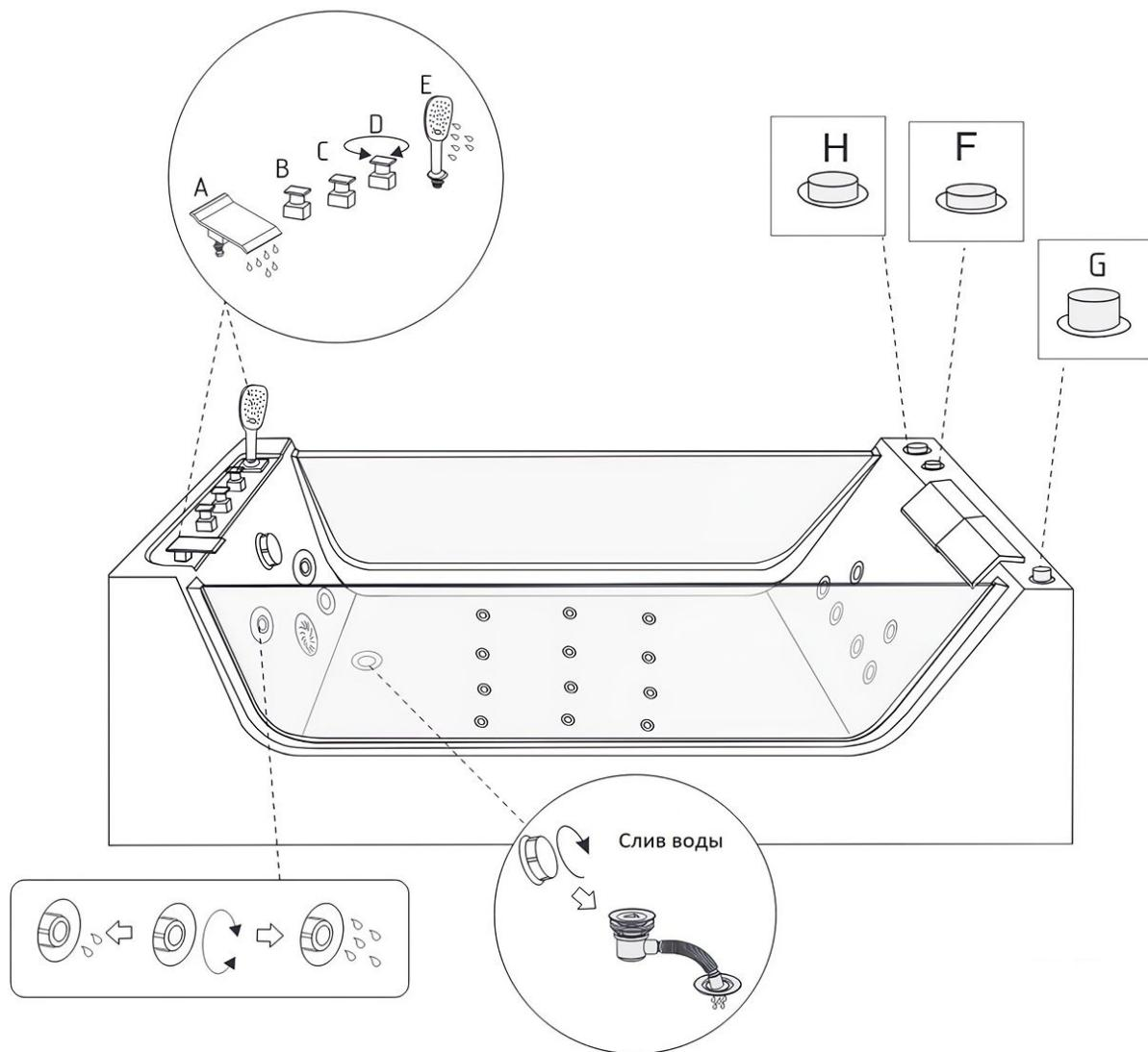
**В** - регулировка холодной воды
